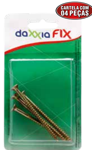
102.28.049 PAR CHIP FIX CABEÇA CHATA FENDA PHILIPS ROSCA AUTO CORTANTE BICROMATIZADO 5,00 X 70 (2.3/4")
