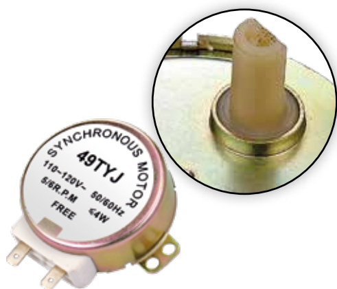
MOTOR P/ FORNO M. ONDAS 5/6RPM 4W 50/60HZ EIXO PLÁSTICO MEIA CANA 22.02.001 - 110V 22.02.002 - 220V
