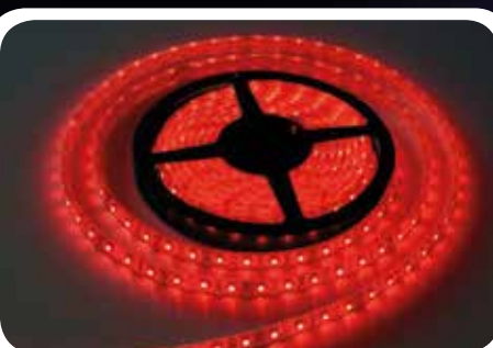
15.12.010 FITA DE LED SMD 3528 60 LEDS/MT TENSÃO 12V, CORTE A CADA 3 LEDS FITA ADESIVA DUPLA FACE PROTEÇÃO: IP65 COR: VERMELHA
